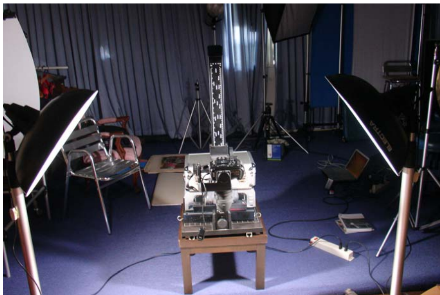
ไฟทำมุม 45 องศา และกล้องยึดติดกับแท่น copy
